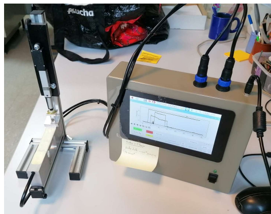
Figure 31. Dispositif expérimental permettant de mesurer la force nécessaire pour écraser une coquille (collaboration Ludovic Guillard et Simon Navel, LEHNA UMR 5023).
